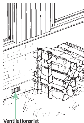
Ventilationsrist til udluftning af krybekælder
